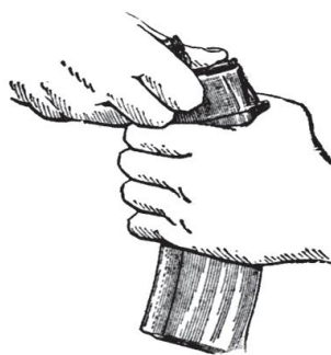
Рис. 134. Зарядження магазину патронами вручну
