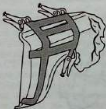
Рис. 12.9 Приклад установа розмічального шаблона на пошкоджену крилу
