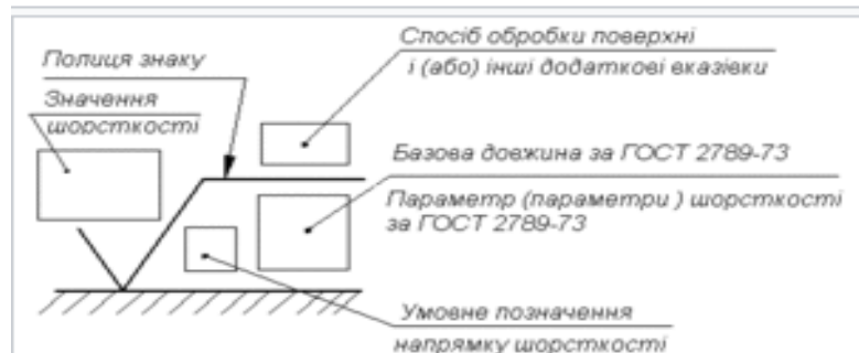
Структура умовного позначення шорсткості на креслениках
